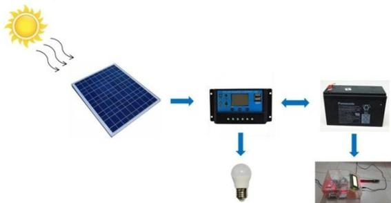
Gambar 1. Blok Diagram Rancang Bangun
