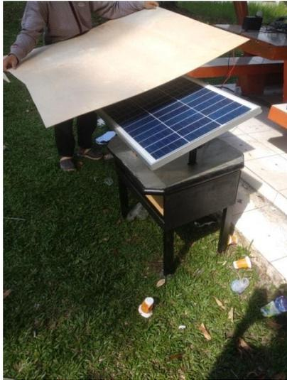
**Gambar 8.** Pengujian Solar Panel dengan Menutup Permukaan Solar
