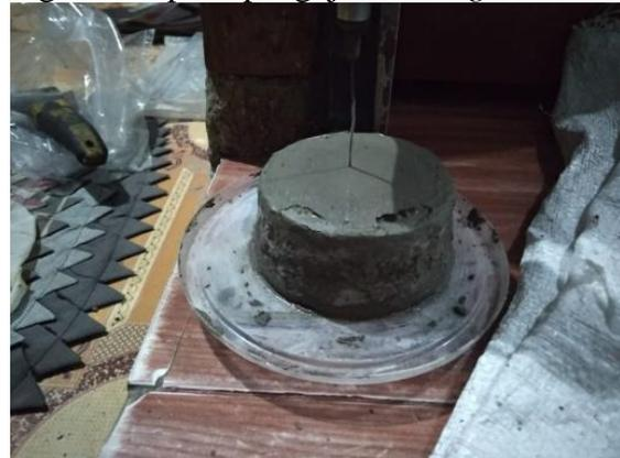
Gambar 1. Pengujian *Setting Time*
