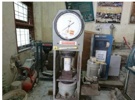
Gambar 2. Pengujian Kuat Tekan Beton
