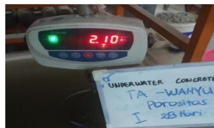
Gambar 7. Penimbangan benda uji silinder beton di dalam air
