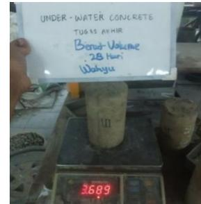
Gambar 6. Penimbangan benda uji silinder beton
