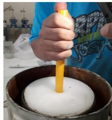
Gambar 3. Sampel konsolidasi horizontal ch
