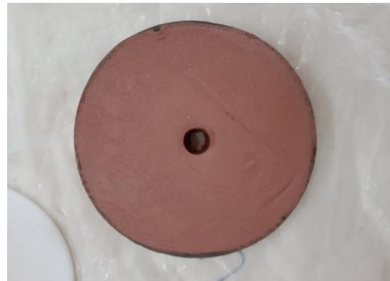
Gambar 2 Sampel Konsolidasi horizontal ( C_h )
