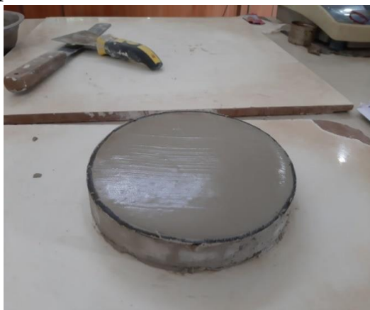
Gambar 1 Sampel konsolidasi vertikal ( C_v )
