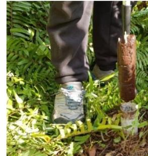
Gambar 9 Mengangkat Alat Secara Perlahan
