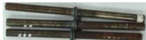
Gambar 14 Hasil sambungan sudut *chamfer* 30°
