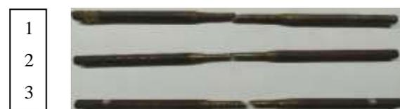
Gambar 19 Hasil uji tarik sambungan las gesek rotari variasi sudut *chamfer* 0°
