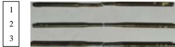
Gambar 21 Hasil uji tarik sambungan las gesek rotari variasi sudut *chamfer* 30°
