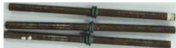
Gambar 13 Hasil sambungan sudut *chamfer* 15°
