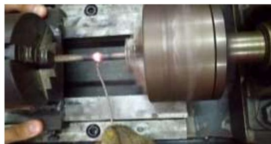
Gambar 9 Proses penyambungan benda kerja dengan metode las gesek rotari
