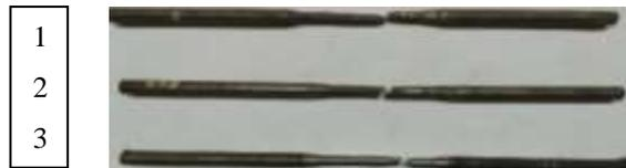
Gambar 22 Hasil uji tarik sambungan las gesek rotari variasi sudut *chamfer* 45°
