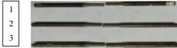
Gambar 20 Hasil uji tarik sambungan las gesek rotari variasi sudut *chamfer* 15°
