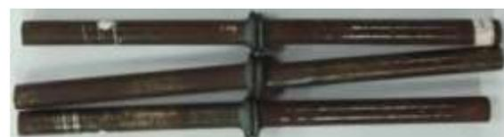
Gambar 15 Hasil sambungan sudut *chamfer* 45°
