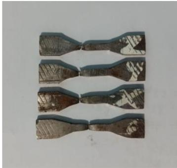
**Gambar 6.** Spesimen Hasil Uji Tarik
