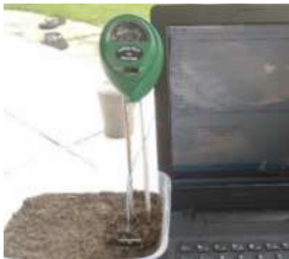
Gambar 9. Validasi Kelembaban Tanah dengan Moist Meter dan Sensor YL-69
