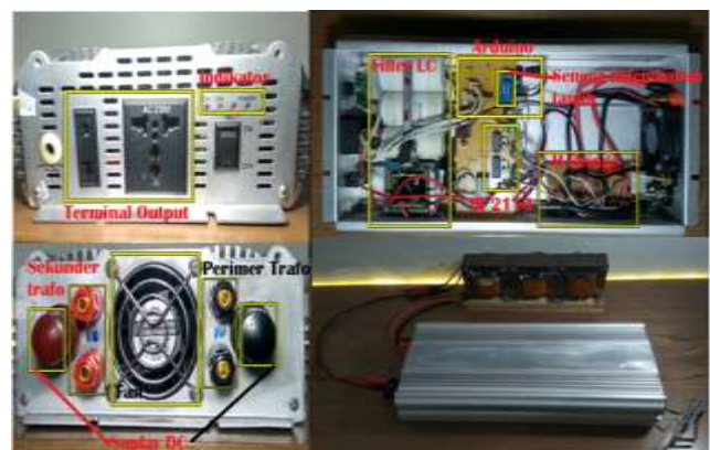
Gambar 6. Rangkaian Keseluruhan Kendali Sistem Inverter
