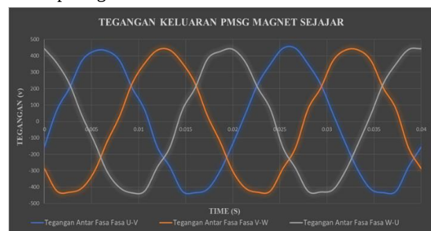
Gambar 13. Hasil gelombang tegangan magnet sejajar.
