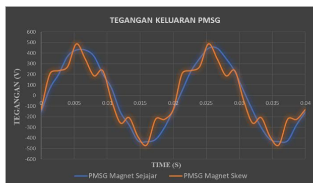
Gambar 16. Kurva karakteristik tegangan PMSG.
