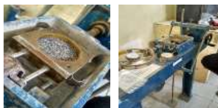
Gambar 18. Pengujian Geser Langsung.
