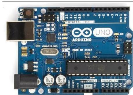
Gambar 1. Mikrokontroler Arduino Uno
