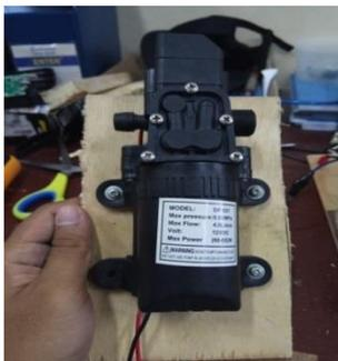
Gambar 10. Motor Pompa Air DC 12 volt
