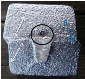
Gambar 10. Cacat pada Sisi Kedua Benda Cor
