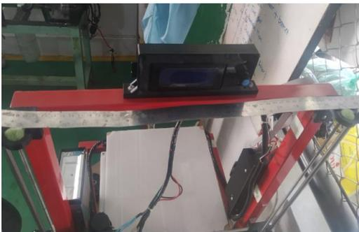
**Gambar 9.** Pengukuran Dimensi Sumbu Z
