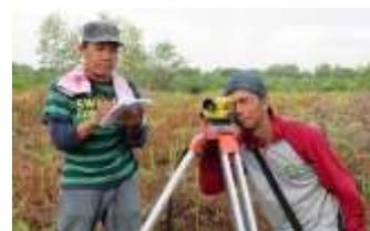
Gambar 6. Pengukuran Elevasi Sumur Pantau
