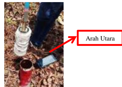
Gambar 7. Memasukkan Alat ke dalam Pipa PVC
