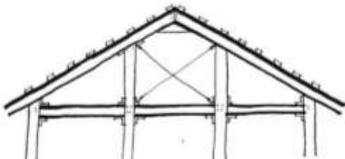
Gambar 9. Contoh Struktur Rangka Baja
