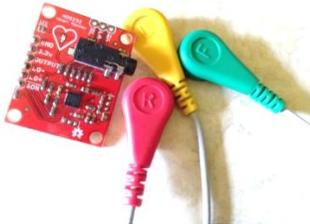
Gambar 4. AD8232 dan EKG Snap Electrode Cables
