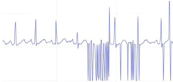
Gambar 9. Sinyal yang diterima pada Kondisi Non-LoS *Serial Plotter* Arduino
