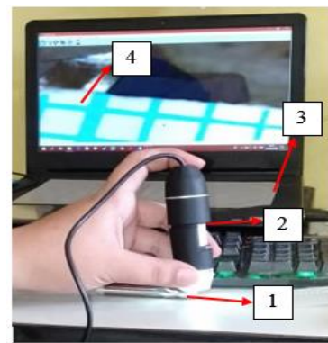
Gambar 3. Set Up Pengukuran Aus Pahat
