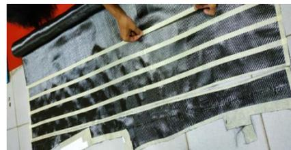
Gambar 9. Proses pemotongan serat karbon
