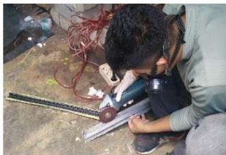
Gambar 13. Proses pemotongan spesimen lengan *tricopter*
