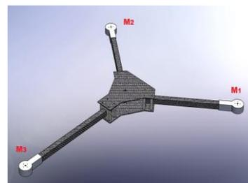
Gambar 3. Desain Rangka *Tricopter*
