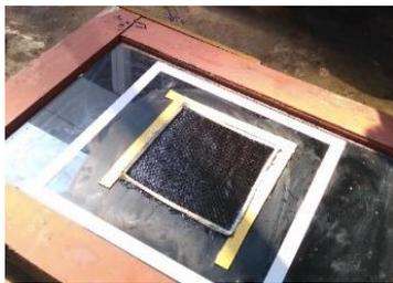
Gambar 18. Proses mengoleskan resin pada serat karbon
