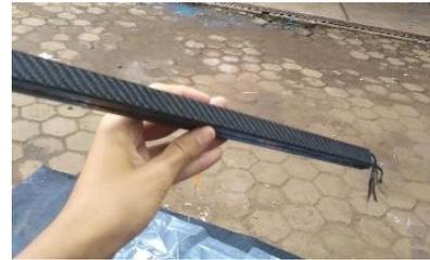
Gambar 14. Hasil penyambungan spesimen lengan
