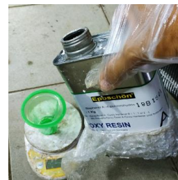
Gambar 15. Menimbang resin dan hardener
