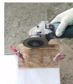
Gambar 6. Pemotongan Spesimen Uji
