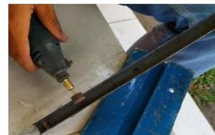
Gambar 8. Proses memotong dan merapikan spesimen
