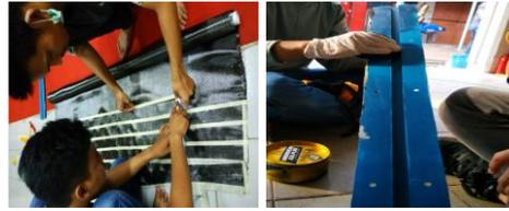
Gambar 6. Proses pemotongan serat karbon dan pemberian wax
