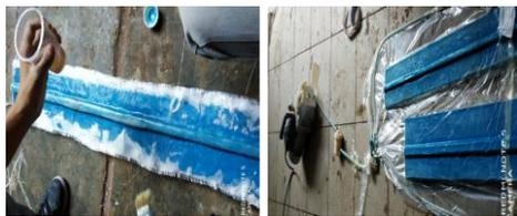
Gambar 4. Proses pembuatan cetakan lengan *quadcopter*
