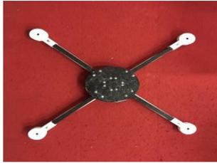
Gambar 15. Hasil Pembuatan Rangka Quadcopter
