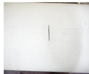
Gambar 4. Retak Ukuran 2 cm
