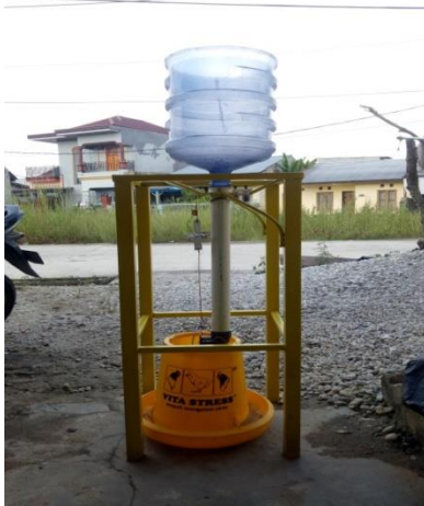
Gambar 6. Desain alat Pemantauan Pakan Ayam Otomatis.
