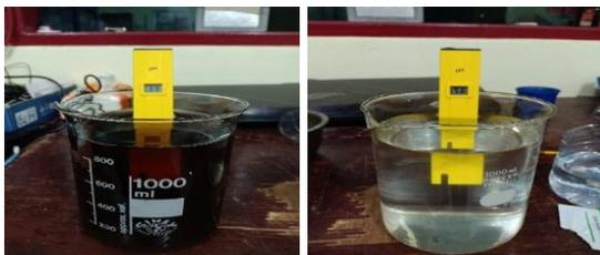
Gambar 1. Pengujian pH Air Gambut dan Air Hujan
