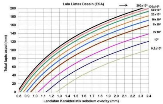
Gambar 4. Solusi *Overlay* Berdasarkan Lendutan Maksimum *Benkelman Beam* Untuk WMAPT 41°C
