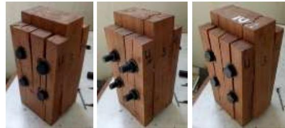
Gambar 15. Benda Uji Sambungan Baut dan Perekat di Lubang Baut Setelah Dilakukan Pengujian.
