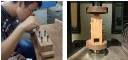
Gambar 11. Skema dan Pengujian Sambungan Baut dan Perekat pada Lubang
