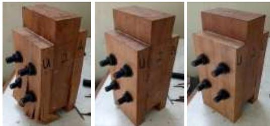
Gambar 14. Benda Uji Sambungan Baut dan Perekat di Bidang Irisan Setelah Dilakukan Pengujian.
