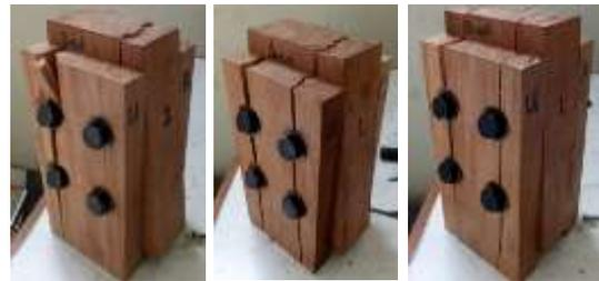
Gambar 12. Benda Uji Sambungan Baut Setelah Dilakukan Pengujian.
