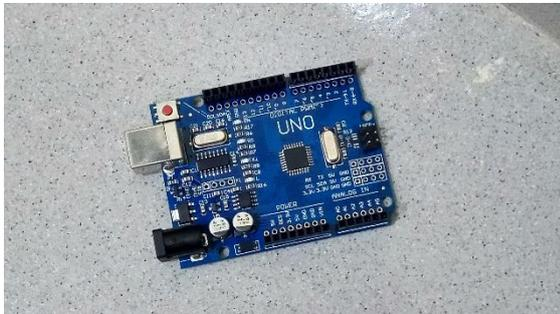
**Gambar 1.** Mikrokontroler Arduino Uno
