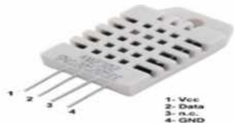
Gambar 3 Bentuk fisik DHT22 (Andhika, 2017)
