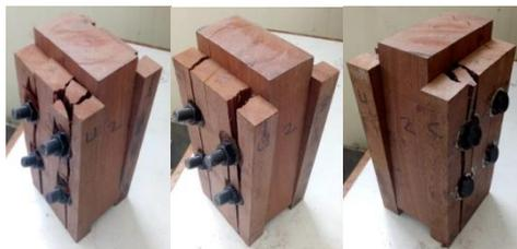
Gambar 12. Benda Uji Variabel 2 Setelah Pengujian
