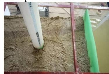
Gambar 15 Persiapan Sumur Pantau
