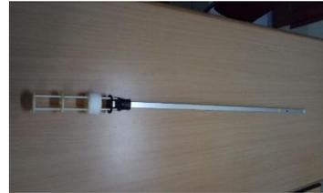
Gambar 10 Tongkat *Paper Disc Velocimeter*
