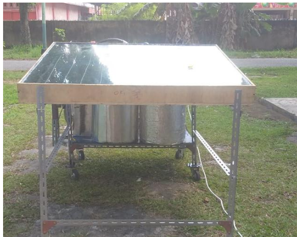
Gambar 4 Pembangkit Listrik Sistem ORC dengan solar collector
