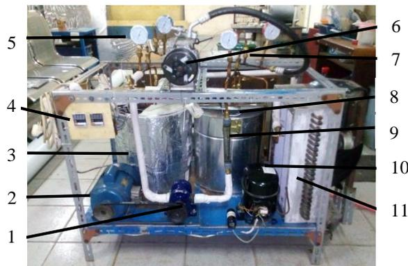
Gambar 5. Hasil Pembuatan Sistem ORC
