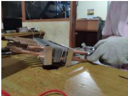
Gambar 5 Proses Memasukkan Tube pada Fin
