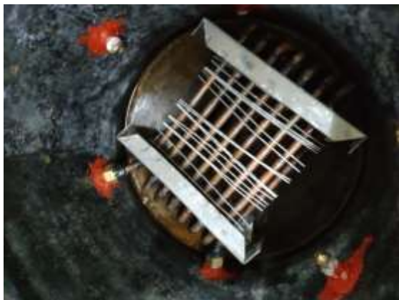
Gambar 7 Alat Penukar Kalor Desorber
