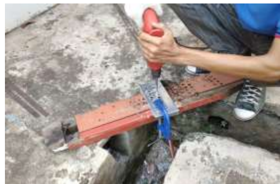
Gambar 4 Proses drill pada tube
