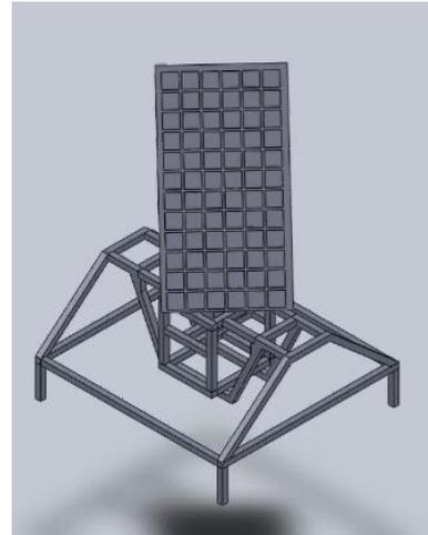
Gambar 8 Rangka Pembangkit Listrik Tenaga Surya Otomatis dengan Software Solid Work
