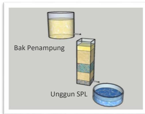
Gambar C.1 Rangkaian Unit Pengolahan Air Bersih Sistem saringan Pasir Lambat
