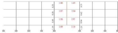
Gambar 15. Nilai DCR Pada Rangka G1-J
