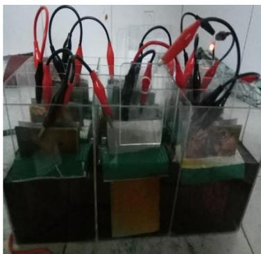
**Gambar 3.1** Sel elektrokimia dengan 12 pasang sel elektroda
