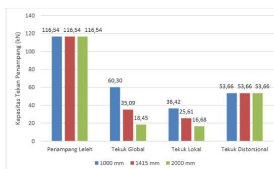
Gambar 16 Kapasitas penampang berdasarkan panjang batang
