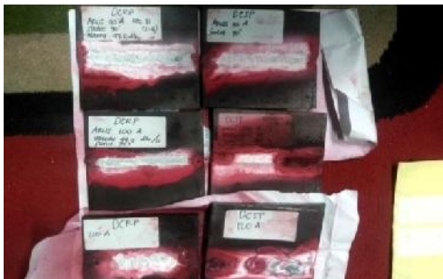
Gambar 3 Hasil Pengujian Liquid Penetrant
