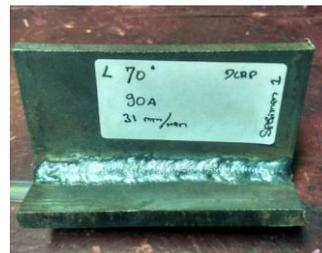
Gambar 12. Hasil Pengelasan Posisi 1F
