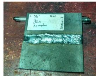
Gambar 11. Hasil Pengelasan Posisi 1G
