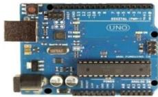
**Gambar 1.** Mikrokontroler Arduino Uno
