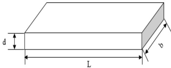
**Gambar 2.** Dimensi Spesimen uji kuat lentur
