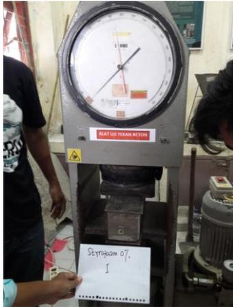
Gambar 1. Pengujian Kuat tekan Bata Beton
