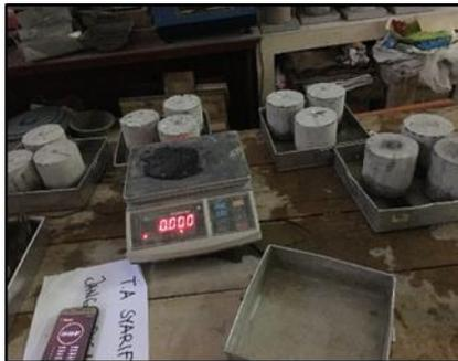
Gambar 3. Pengujian Sorptivity
