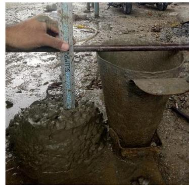
Gambar 2. Pengujian *Workability*
