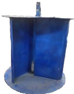
**Gambar 4.** Hasil Pembuatan turbin savonius *type bach* tiga sudu
