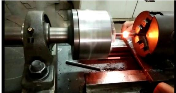
Gambar 12 Proses Pengelasan dengan Mesin Rotary Friction Welding
