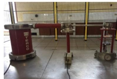
**Gambar 2.** Rangkain AC sebagai rangkaian Pengujian di laboratorium Tegangan Tinggi Fakultas Teknik UNRI
