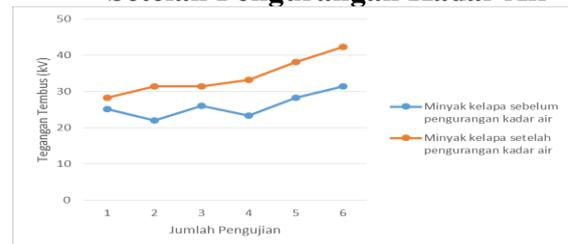
Gambar 5. Kurva Perbandingan hasil pengujian minyak kelapa sebelum dan sesudah pengurangan kadar air
