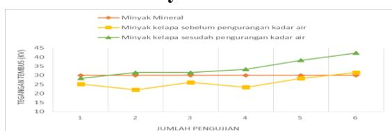
Gambar 4. Kurva pengujian tegangan tembus minyak isolasi
